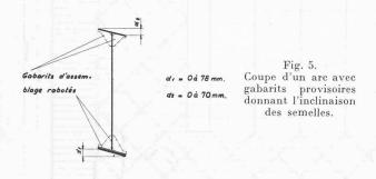
la mesure est donnée par la cote d, varie de 0 à 78 mm, suivant que l'on se trouve à la clef ou à la naissance. Les âmes des poutres n'ont pas été chanfreinées; la liaison âmesemelle est assurée par des cordons d'angle de 6 à 8 mm. L'épaisseur de l'âme varie de 8 mm à la clef à 10 mm à la naissance. La hauteur de l'âme étant faible et les efforts tranchants peu importants, la sécurité au voilement est assurée sans intervention de raidissements.
