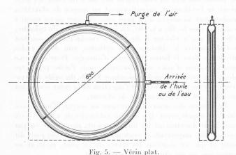
Le pointillé indique la limite du bloc-vérin en béton.
