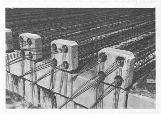
Fig. 10. — En haut : schémas de la précontrainte par câbles. En bas : pieux précontraints par 4 câbles, prêts au coulage. Les 4 « cônes » Freyssinet sont noyés dans la pièce d'about.
