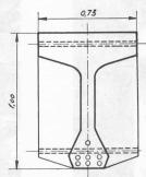
Fig. 21. — Section au milieu d'une poutre de 21 m en 5 éléments précontraints par câbles.
