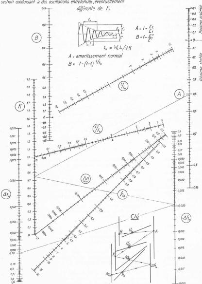
Nomogramme donnant les relations entre la section de la chambre, l'amortissement de l'oscillation et l'écart de la puissance maximum.
