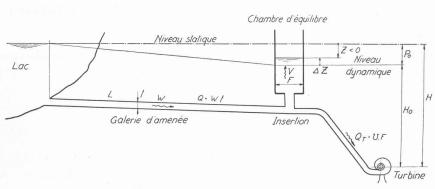
Fig. 1. — Schéma d'aménagement hydroélectrique muni d'une chambre d'équilibre.
