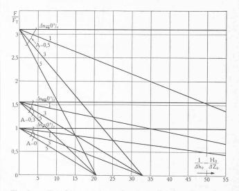
Fig. 4. — Relation entre la section de la chambre, l'amortissement de l'oscillation et l'écart de puissance maximum.
