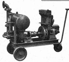
Débits de 1 à 500 litres/seconde. — Pas de soupape de pied, ni de clapet dans la tubulure d'aspiration. — Aucune pompe à vide de secours. — Réamorçage automatique immédiat, même si de l'air est entré dans le tuyau d'aspiration. — Pas de surfaces de joint présentant des frottements et s'usant, par conséquent insensibilité à l'action des limons, du sable et des graviers.
