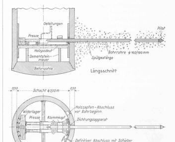
Fig. 5. — Eléments principaux de l'installation pour captages horizontaux. - Echelle 1:100.
