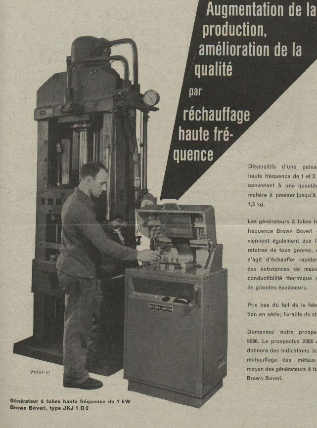
Dispositifs d'une puissance haute fréquence de 1 et 2 kW, convenant à une quantité de matière à presser jusqu'à env.
