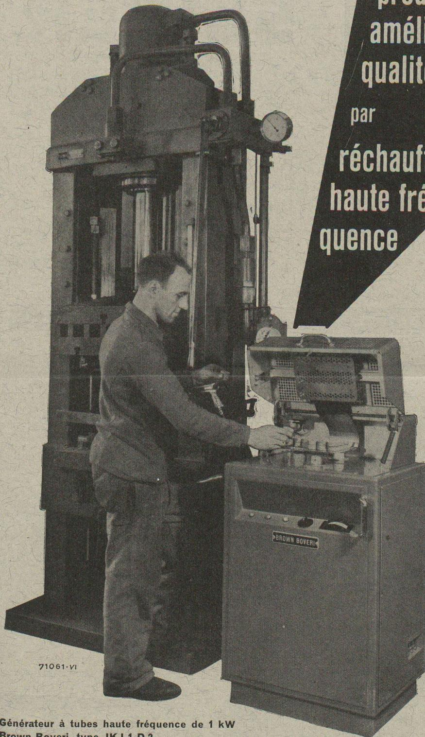
Générateur à tubes haute fréquence de 1 kW
