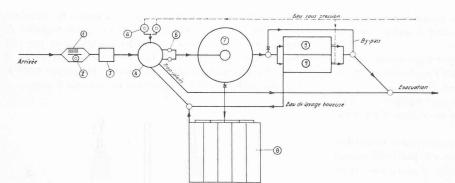
Fig. 40. — Schéma du traitement des eaux résiduaires des abattoirs de Genève.
