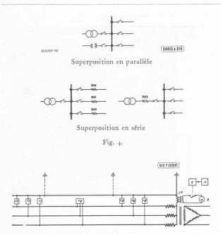
Fig. 5. — Superposition monophasée série sur un réseau à basse tension.
