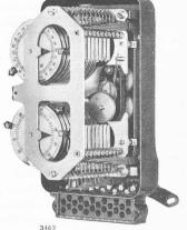
Fig. 11. Récepteur pour trois doubles commandes. avec indicateurs de de position.
