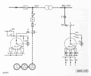
Fig. 6. — Schéma de principe d'une télécommande L &G avec superposition en parallèle et injection dans un réseau à haute tension de 8 kV
