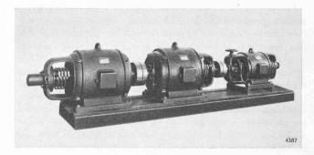
Fig. 3. — Groupe convertisseur à fréquence audible de 20 kVA, se composant d'un générateur, d'un moteur asynchrone et d'un convertisseur de fréquence.
