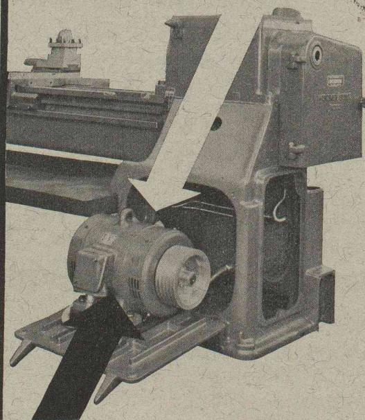
... Démarrages et freinages aussi fréquents sont trop pour une isolation normale.
