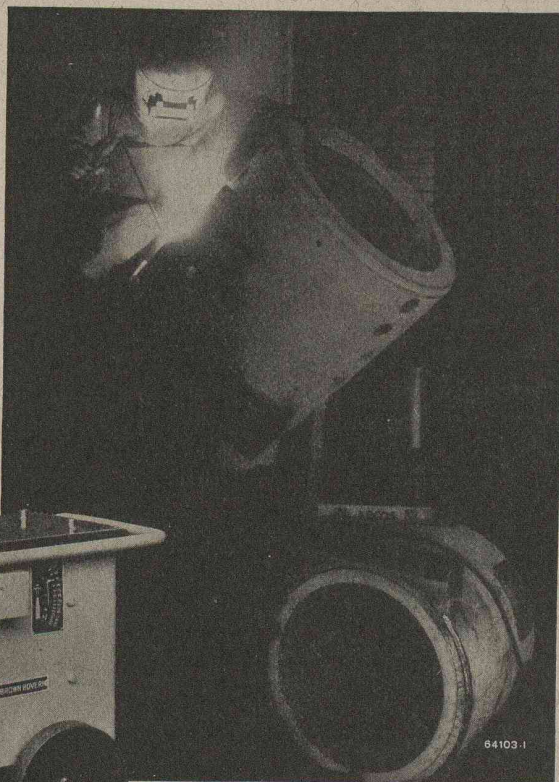
Soudure de carcasses de moteurs pour véhicules électriques.
