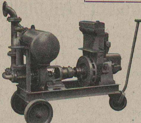
Débits de 1 à 500 litres/seconde. — Pas de soupape de pied, ni de clapet dans la tubulure d'aspiration. — Aucune pompe à vide de secours. — Réamorçage automatique immédiat, même si de l'air est entré dans le tuyau d'aspiration. — Pas de surfaces de joint présentant des frottements et s'usant, par conséquent insensibilité à l'action des limons, du sable et des graviers.
