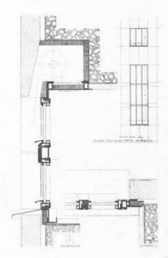
Fig. 21. — Détail de fenêtre. — Ecbelle 4 : 20.
