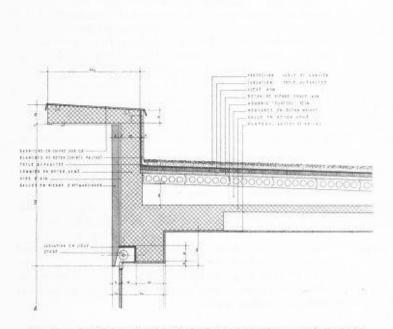
Fig. 20. — Détail de la Corniche du bâtiment de service. — Echelle 1 : 40.
