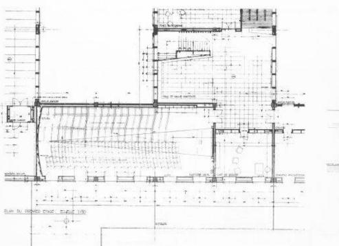
Fig. 15. — Plan'du 1<sup>er</sup> étage. — Détail d'un auditoire. — Echelle 1<sup>e</sup> 300.
