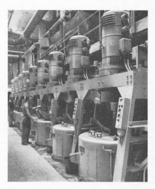
Fig. 2. — Centrifuges de grande puissance de la raffinerie d'Aarberg avec moteurs isolés au «Vetrotex» (BBC),
