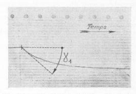
Fig. 13. — Intervention d'un ordre de réglage. Exemple de relevé de la courbe d'écart de réglage d'un régulateur accéléro-tachymétrique
