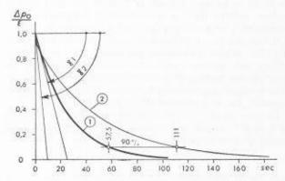
Fig. 11. — Intervention d'un ordre de réglage. Réponse d'un régulateur accéléro-tachymétrique (courbe n° 1) et réponse d'un régulateur tachymétrique avec asservissement temporaire (courbe n° 2)  $\delta' = 0.25$
