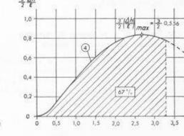
Fig. 10 a,b,c. — Régulateur tachymétrique avec asservissement temporaire  $\delta'=0,25$  sollieité par une modification de la charge consommée en présence d'un phénomène de coup de bélier.
