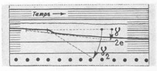
Fig. 14. — Intervention d'un ordre de réglage. Exemple de relevé de la courbe d'écart de réglage d'un régulateur tachymétrique avec asservissement temporaire.
