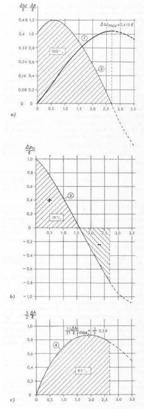
Fig. 9 a, b, e. — Régulateur accéléro-tachymétrique sollicité par une modification de la charge consommée en présence d'un phénomène de coup de bélier,
