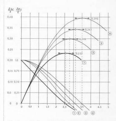
Régulateur accéléro-tachymétrique (Courbe 1) et régulateurs tachymétriques avec asservissement temporaire (Courbes  $2:\delta'=0,30,\ 3:\delta'=0,25,\ 4:\delta'=0,20)$  sollicités par une modification de la charge consommée. Ecart de vitesse  $\Delta w$  et Ecart de réglage  $\Delta p_o$ .
