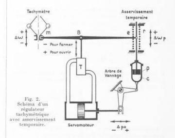
ceux du manchon (m) du tachymètre, attelé à l'une des extrémités du balancier (B), et de ceux du mécanisme d'asservissement temporaire, comportant les éléments essentiels suivants:
