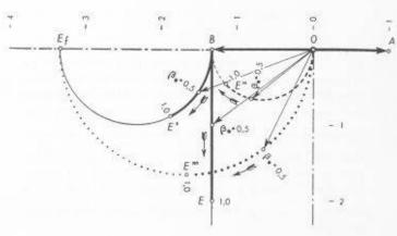
Fig. 5. — Comparaison avec la courbe de comportement du régleur tachymétrique avec asservissement permanent.
