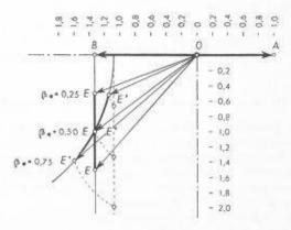
Fig. 7. — Courbes de comportement d'un régleur accéléro-tachymétrique et d'un régleur tachymétrique avec asservissement temporaire réalisant le même pouvoir stabilisateur pour  $\beta_* = 0.5$  sec $^{-1}$ .
