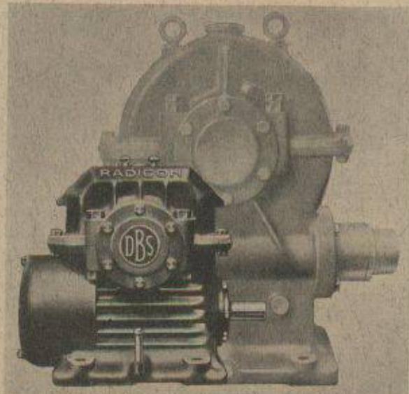
Refroidissement forcé, circulation d'huile à l'engrenage et aux roulements, profil des filets breveté, charge et rendement élevés malgré dimensions réduites, moins cher pour puissance donnée que réducteur à vis ordinaire, sûr, silencieux.
