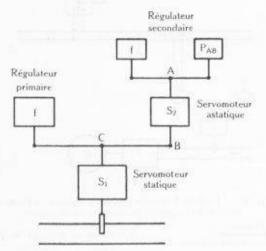
Fig. 4. — Schéma d'un réglage fréquence-puissance indirect.
