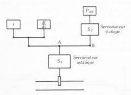
Fig. 6. - Schéma d'un réglage fréquence-puissance direct.
