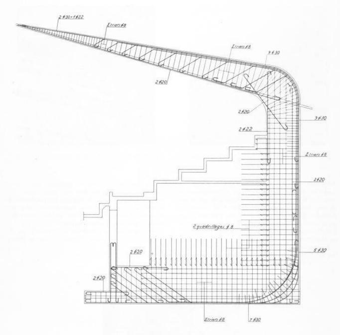
Fig. 5. - Armature d'une ferme. (Ech. 1:60.)
