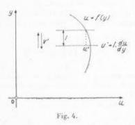
Soient A et B deux couches liquides en mouvement à des vitesses  $u_i$  et  $u_k$ . Par suite de la turbulence, il y a échange de particules à une vitesse v' entre A et B, ou échange de leurs quantités de mouvement.
