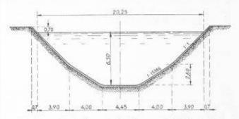
Fig. 10. — Canal d'amenée. Profil type nº 2. (Ech. 1:300)
