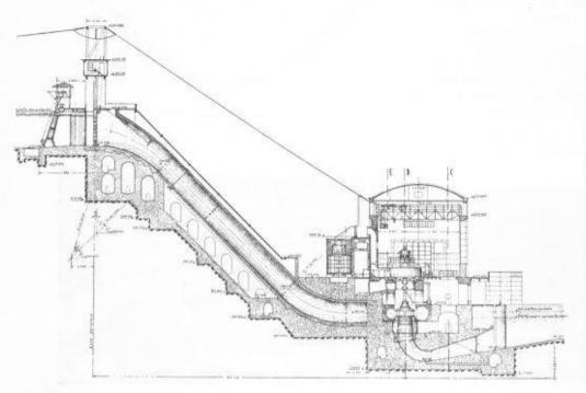
Fig. 12. — Usine de Bussolengo, Coupe de l'installation. (Ech. 1:750),
