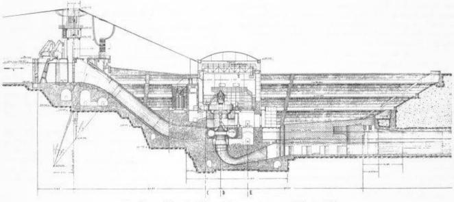
Fig. 17. - Usine de Chievo, Coupe en travers, (Ech. 1:750).
