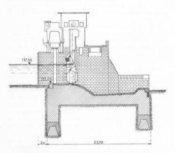
Fig. 2, — Coupe en travers du barrage, (Ech. 1:400).
