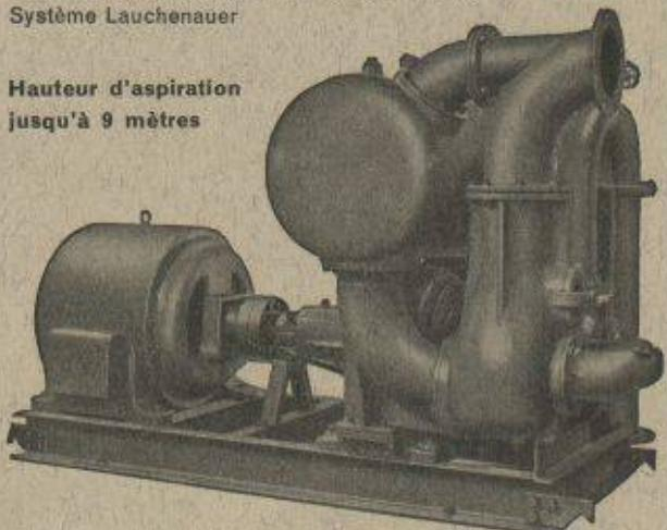
Débits de 1 à 500 litres/seconde. — Pas de soupape de pied, ni de clapet dans la tubulure d'aspiration. — Aucune pompe à vide de secours. — Réamorçage automatique immédiat, même si de l'air est entré dans le tuyau d'aspiration. — Pas de surfaces de joint présentant des frottements et s'usant, par conséquent insensibilité à l'action des limons, du sable et des graviers.
