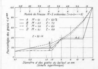
Fig. 1. - Granulation des bétons A, B, C, D
