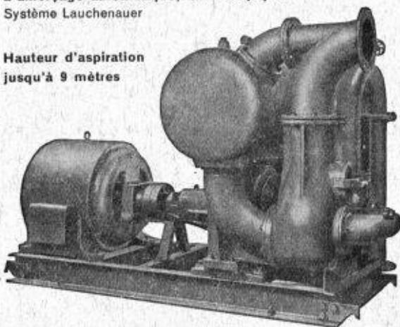
Débits de 1 à 500 litres/seconde. — Pas de soupape de pied, ni de clapet dans la tubulure d'aspiration. — Aucune pompe à vide de secours. — Réamorçage automatique immédiat, même si de l'air est entré dans le tuyau d'aspiration. — Pas de surfaces de joint présentant des frottements et s'usant, par conséquent insensibilité à l'action des limons, du sable et des graviers.
