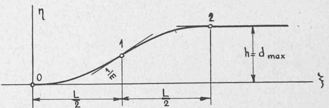
être tangente au point 0 à l'axe des  $\xi$  et au point 2 à une // à l'axe des  $\xi$ . Les points 0, 1 et 2 seront des points d'inflexion.
