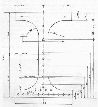
Fig. 10. — Poutre d'essai, août 1944 : coupe transversale.
