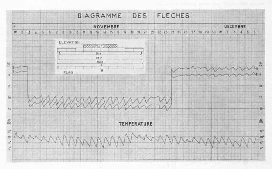
Fig. 8. — Diagramme des flèches de la poutre d'essai constituée de dix éléments.
