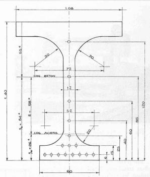
Fig. 4. — Poutre d'essai, juin 1944 : coupe transversale.
