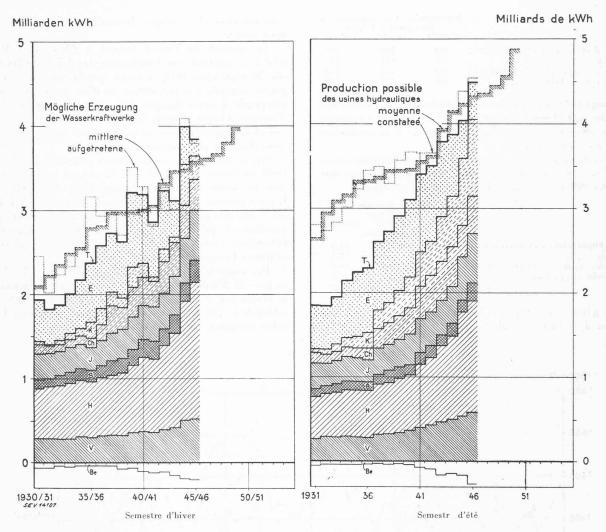
Fig. 2. — Production possible et livraisons d'énergie pendant les semestres d'hiver et d'été. La courbe de la production moyenne possible indique l'augmentation future de la production par la mise en service des usines actuellement en construction.
