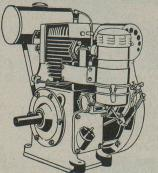
le moteur à 1 cylindre de grande capacité; très maniable avec régulateur automatique, 4 temps, refroidissement à l'air, économique en benzine.
