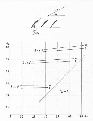
Fig. 11. — Comparaison entre les résultats obtenus par la méthode électrolytique (a) et en soufflerie (b).
