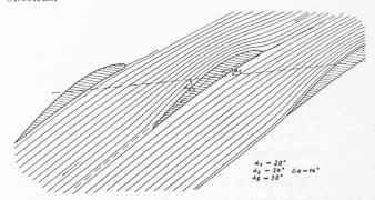
Fig. 7. — Lignes de courant relevées au bassin.
