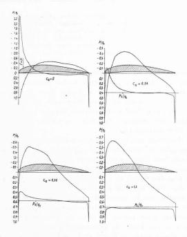
Fig. 9. — Répartition des pressions sur le profil.
