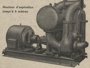
Débits de 1 à 500 litres/seconde. — Pas de soupape de pied, ni de clapet dans la tubulure d'aspiration. — Aucune pompe à vide de secours. — Réamorçage automatique immédiat, même si de l'air est entré dans le tuyau d'aspiration. — Pas de surfaces de joint présentant des frottements et s'usant, par conséquent insensibilité à l'action des limons, du sable et des graviers.
