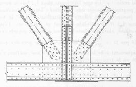
Fig. 4. — Type de nœud usuel avec gousset, à diagonles centrées.
