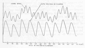
Fig. 12. - Couple moteur pour dix-huit cylindres en étoile.
