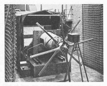
Montage pour vérifier les vitesses critiques d'arbres porte-hélice.
