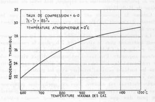
Fig. 8. — Variations du rendement thermique avec la température.
