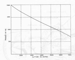
Fig. 4. — Variation de la poussée avec l'altitude.
