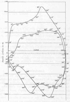
Fig. 13. — Poussée latérale exercée pendant deux tours du vilebrequin par le piston sur le cylindre maître dans un moteur à dix-huit cylindres en double étoile.
