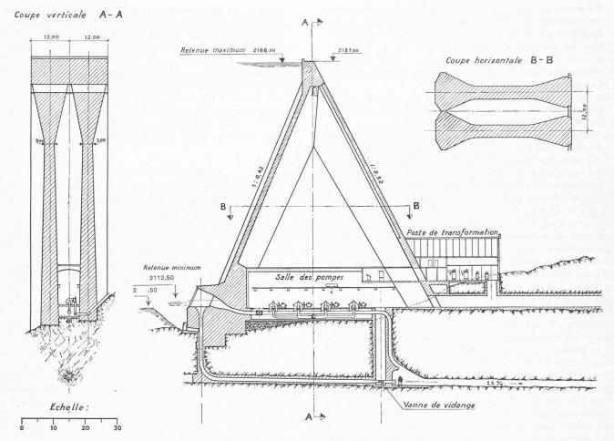
Fig. 6. — Barrage Coupe transversale, station de pompage et vidange.
