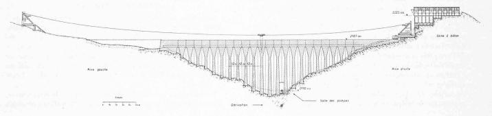
Fig. 7. — Barrage. Coupe longitudinale et blondins.
