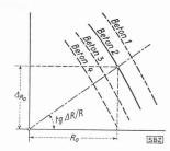
Fig. 39. — Courbes expansives dynamiques des divers bétons.
