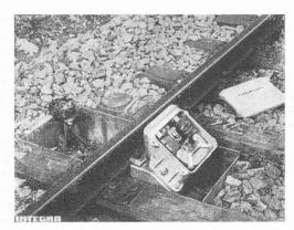
Fig. 10. — Pédale électro-magnétique pour le comptage des essieux.
