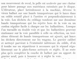
Pendant son travail la dégarnisseuse est propulsée à une vitesse en relation avec celle de la chaîne porte-outils. Au fur et à mesure de l'avancement, la voie dégarnie est calée sous la machine avec des plots de bois pourvus de poignées, complétées par des coins en bois dur ; ils sont retirés quand la voie repose sur le ballast récupéré.
