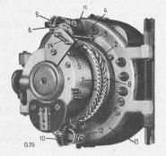
Fig. 16. — Cadran à correction astronomique. et 8. Couronnes à taillages hélicoïdaux faisant une révo-lution par année. lution par annee.
