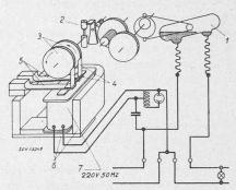
Fig. 24. — Schéma du télérelais récepteur.
