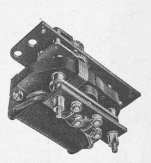
Fig. 12. — Moteur asynchrone à rotor en court-circuit.
