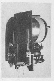
Fig. 13. — Un des premiers servo-moteur oscillant.
