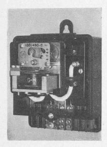
Fig. 25. — Télérelais monté dans son boîtier.
