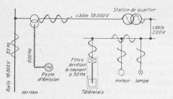
Fig. 19. — Principe du système Actadis.
