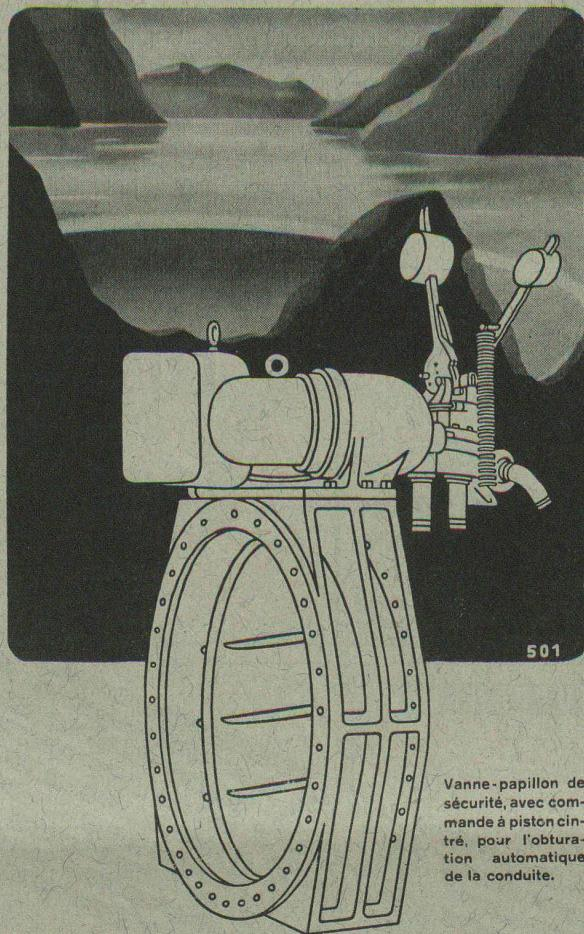
Vanne-papillon de sécurité, avec commande à piston cintré, pour l'obturation automatique de la conduite.
