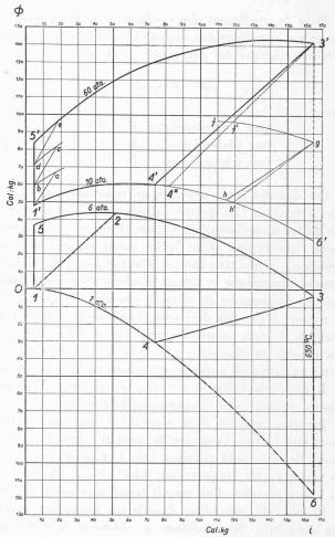
Fig. 4. — Comparaison entre un cycle avec compression isothermique, échanges de chaleur isobares et détente isentropique parcouru par l'air en circuit ouvert (basses pressions) et en circuit fermé (hautes pressions) avec diverses autres indications complémentaires.
