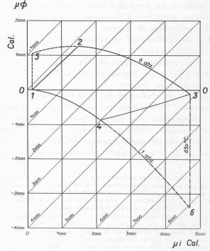
Fig. 3. — Représentation en μi— μφ des cycles théoriques auxquels il est possible de recourir dans le cas des installations à circuit ouvert.
