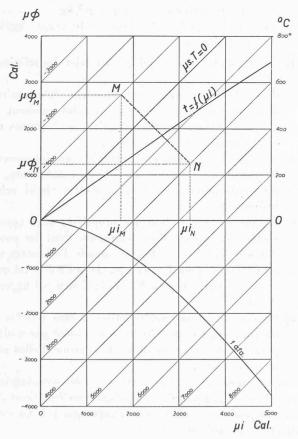
Fig. 1. — Disposition générale des diagrammes  $\mu i$ — $\mu \phi$  avec réseau de droites  $\mu s.T=$  const. et courbe de température en fonction des valeurs de  $\mu i$ .
