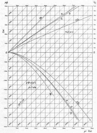
Fig. 2. — Diagramme  $\mu i - \mu \phi$  avec courbes  $t = f(\mu i)$  et p = 1 atapour air, gaz de combustion moyen,  $N_2$ ,  $CO_2$ , He.
