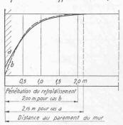
a) Béton de ciment dégageant sa chaleur de prise de façon régulière, a') Dérivée de la courbe d'échaussement interne a, proportionnelle au nombre de calories dégagées par unité de volume et par unité de temps.
