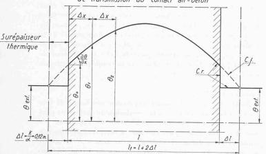
Fig. 27. — Températures au voisinage des faces d'un mur.
