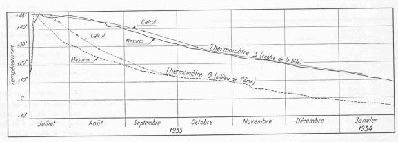
Fig. 31. — Comparaison entre les températures mesurées et les températures calculées, pendant le premier refroidissement du pilier 13.
