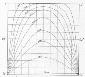
Pour obtenir les états thermiques d'un massif d'épaisseur e, soumis à une variation de température  $\overline{I}$ , il suffit de multiplier les longueurs par e, les temps par  $e^2$ , les températures par  $\overline{I}$ .  $\left(a-\frac{K}{PC}-2,5\times10^{-5}\frac{m^4}{h}\right)$
