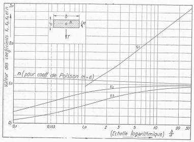
Fig. 33. — Coefficients de déformation du rocher (d'après Vogt).
