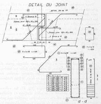
Fig. 14. — Exemple d'armatures d'une poutre.
