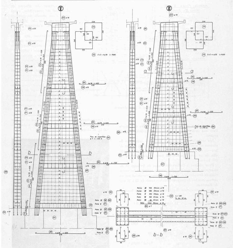
Fig. 15. — Exemple d'armatures dans deux palées.
