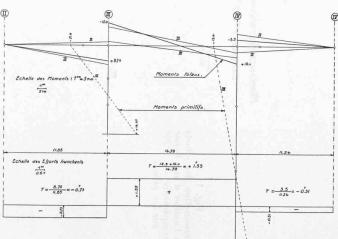
Fig. 13. — Courbes des moments fléchissants et des efforts tranchants maxima et minima dans une poutre du tablier. Schéma de répartition des armatures.
