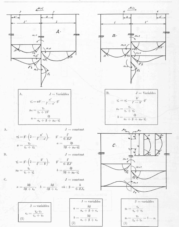
Fig. 5. — Résumé des formules pour la détermination des foyers et des cœfficients de passage.
