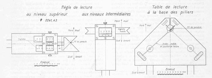
Fig. 14. — Barrage de la Dixence. — Dispositifs de mesure des déplacements.
