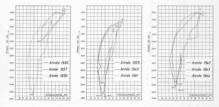
Fig. 26. — Barrage de la Dixence. — Déplacements du sommet du pilier 9 en fonction du niveau du lac.
