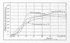
Fig. 15. — Barrage de la Dixence, Elévations de température observées au pilier 13 pendant la phase d'échauffement du béton.
