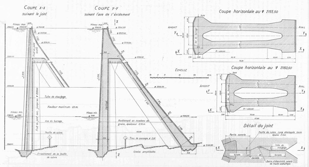
Fig. 5. — Barrage de la Dixence. — Coupes transversale et horizontale, détail du joint.
