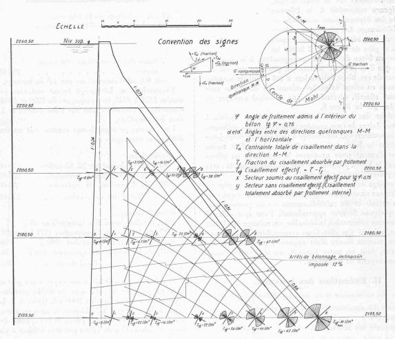
Fig. 8. — Barrage de la Dixence. Stabilité d'un pilier : lignes isostatiques et directions de cisaillement effectif sous les effets cumulés du poids propre et de la poussée de l'eau.
