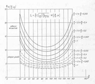
Fig. 13. — Détermination de la fréquence fondamentale  $f_r$  d'une plaque oblique. Représentation graphique de la fonction  $\Psi\left(\frac{a}{h},\alpha\right)$ .
