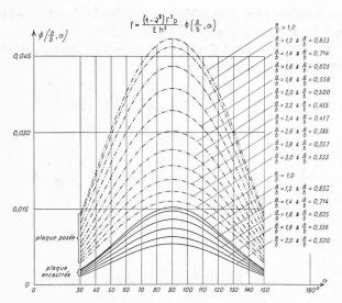
Fig. 12. — Détermination de la flèche / d'une plaque oblique à charge uniformément répartie. Représentation graphique de la fonction  $\Phi\left(\frac{a}{L},\alpha\right)$ .
