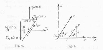
— En coordonnées cartésiennes rectangulaires, les composantes  $\sigma_x$ ,  $\sigma_y$ ,  $\tau_{xy}$  d'un état de tension bi-dimensionnel peuvent s'écrire sous la forme suivante :
