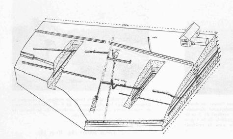
Fig. 5. — Stéréogramme montrant la disposition du puits de recherche foncé en 1942, et de la galerie principale. On voit bien la façon dont le lignite et les graviers qui les surmontent sont pincés entre les moraines.
