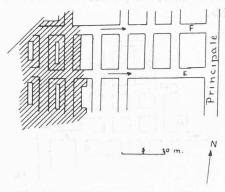
Fig. 10. — Dépilage par longs piliers.
