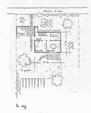
Type C Maisons isolées de 5 pièces. 1 étage sur rez-de-chaussée. Chauffage par poêle installé dans la chambre commune.
