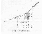
Vérification. La somme des ordonnées de la parabole quadralique, ligne 4, doit être égale à 4 fois le désaxement a de l'axe théorique, soit 4 × 0,0624 = 0,2496 m ou 24,96 cm, la somme des ordonnées étant de 21,77 cm, la différence en moins de 3,19 cm, correspond à la surface hachurée de la figure 17 qui a pour mesure
