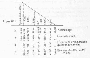
Fig. 18. — Diagramme des flèches de la courbe de raccordement à la sortie de la courbe.
