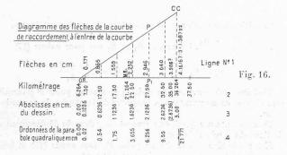
intervalles de la courbe de raccordement que l'on peut mesurer aussi directement sur un diagramme des flèches en grandeur naturelle. Pour un point quelconque P du diagramme des flèches, l'ordonnée correspondante y de la parabole quadratique de la somme des flèches a pour valeur la surface du triangle  $PP_1$  OR, en se rappelant que nous sommons des flèches et qu'il faut par conséquent diviser la surface par  $\Delta l$ .
