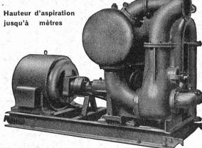
Débits de 1 à 500 litres/seconde. — Pas de soupape de pied, ni de clapet dans la tubulure d'aspiration. — Aucune pompe à vide de secours. — Réamorçage automatique immédiat, même si de l'air est entré dans le tuyau d'aspiration. — Pas de surfaces de joint présentant des frottements et s'usant, par conséquent insensibilité à l'action des limons, du sable et des graviers graviers.
